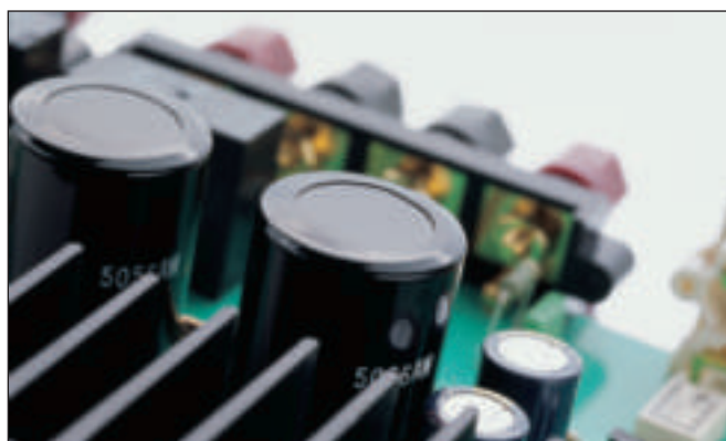
Ogni componente è frutto di scelte precise, tese al raggiungimento delle massime prestazioni sonore. In foto, in primo piano, i condensatori di filtro dell'integrato RA-06
