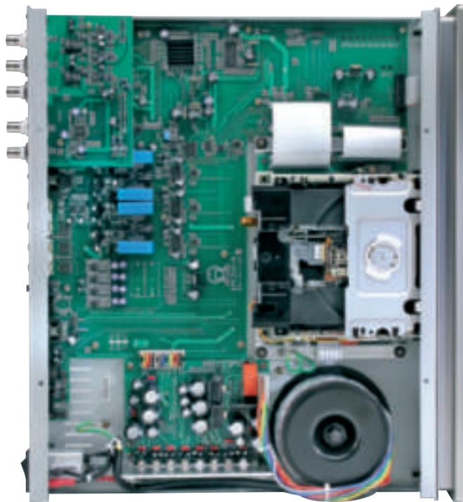
La costruzione del DVD30 è di livello elevatissimo. Regna l'ordine e la qualità dei componenti adottati è eccellente. Notare, in basso a destra, il grosso trasformatore toroidale di alimentazione.
