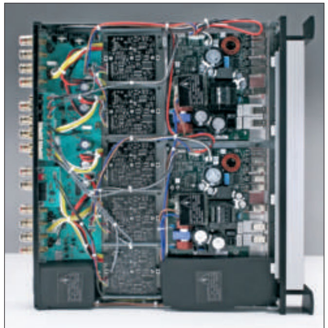
Notare sulla destra i due grossi moduli Ice Power che danno energia anche agli altri 5, situati in posizione centrale.
