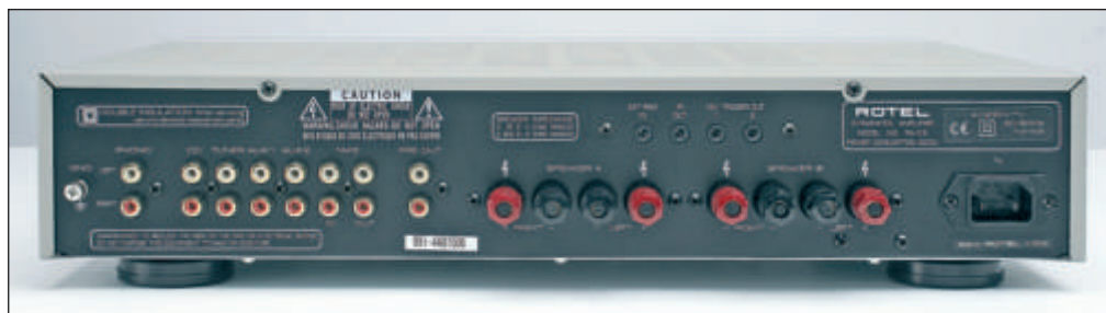
L'RA-03 possiede molti ingressi, phono per giradischi compreso. I morsetti per i diffusori possono accogliere due coppie di casse selezionabili dal pannello frontale, ed è anche presente una uscita pre-out per utilizzare l'integrato solo come preamplificatore e deputare a stadi esterni l'amplificazione di potenza
