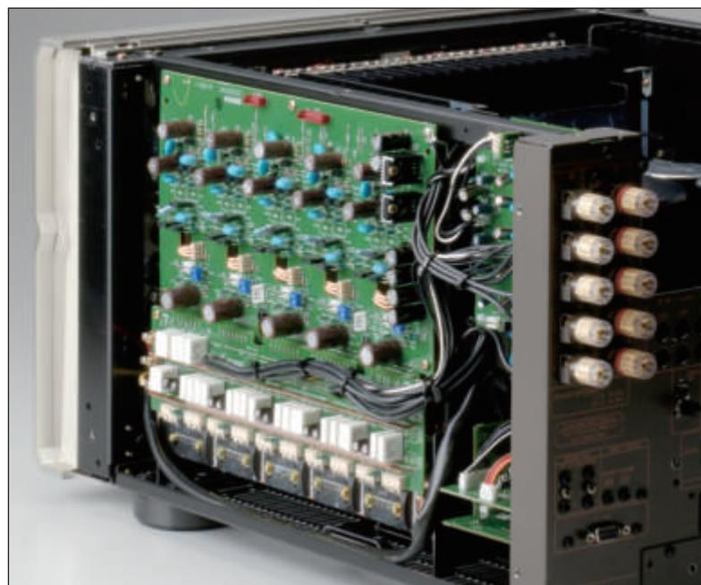
Una delle schede di amplificazione finale sistemata su un fianco dell'apparecchio. I dispositivi di potenza sono montati in fondo ed assicurati ad una grossa aletta di raffreddamento. Notare i morsetti per i diffusori di grandi dimensioni e in grado di serrare ogni tipo di terminazione.
