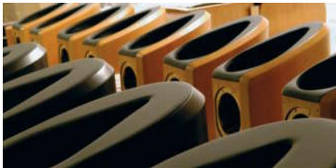
La costruzione e rifinitura dei mobili della nuova Serie 800, avviene in modo maniacale, e nulla è lasciato al caso. In foto i cabinet della 802 pronti per il montaggio dei componenti.
