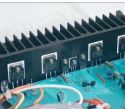
*Nell'RB03 sono utilizzate due coppie di transistor per ogni canale, in modo da garantire una più che generosa erogazione di corrente istantanea.*
