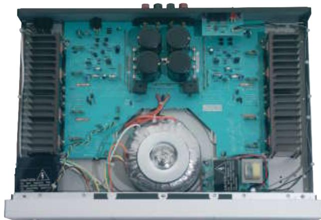
*La costruzione dell'RB03 è molto solida e sono utilizzati componenti di grande livello. notare il robusto trasformatore di alimentazione, che è l'unico elemento in comune tra i due canali. Tutto il resto dell'architettura è completamente dual-mono.*
