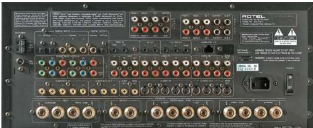
Il parco ingressi è particolarmente folto, ed è in grado di accogliere ogni tipo di sorgente audio/video, audio multicanale e digitale. Notare le biccie di uscita per i diffusori, molto grandi ed in grado di accogliere qualsiasi tipo di cavo.
