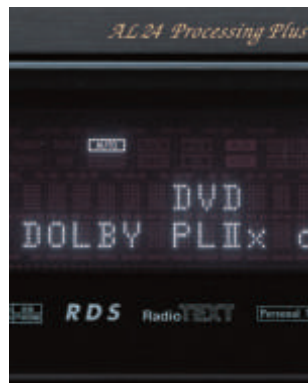
Il display a bordo dell'AVR-3805 è molto esauriente. Si snocciola su due righe di testo e su numerose icone di segnalazione; è costituito da una matrice di punti facilmente leggibile.
