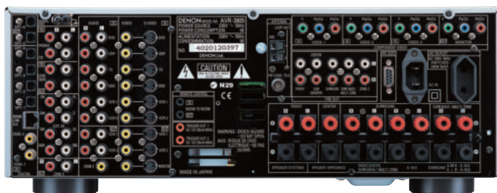
Il parco ingressi/uscite del 3805 è impressionante. Sembra di avere a che fare con un oggetto di una classe di prezzo completamente diversa. Eccezionali possibilità sia audio che video, anche attraverso il convertitore interno da videocomposito/SVideo in component.
