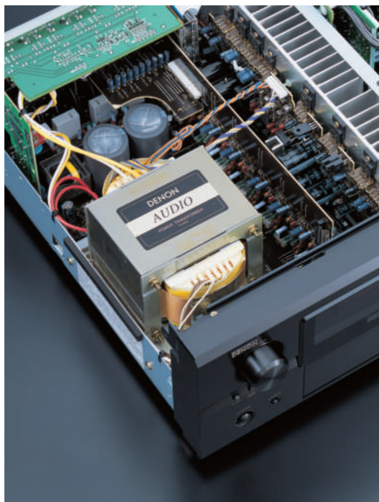
Il trasformatore adottato dall'AVR-3805 è più che surdimensionato, a garanzia di elevate correnti erogabili dagli stadi finali.
