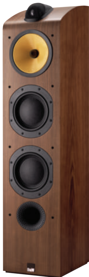
703 Le 703 sono dei diffusori a 3 vie/4 altoparlanti di caratteristiche eccezionali. 2 woofer in carta/kevlar da 16,5 cm, un mid in tecnologia FST da 16 cm e un tweeter Nautilus a cupola da 2,5 cm. Non meno importante il mobile, costruito con rara precisione e seguendo particolari accorgimenti, che lo rendono particolarmente rigido, oltre che estremamente bello.
