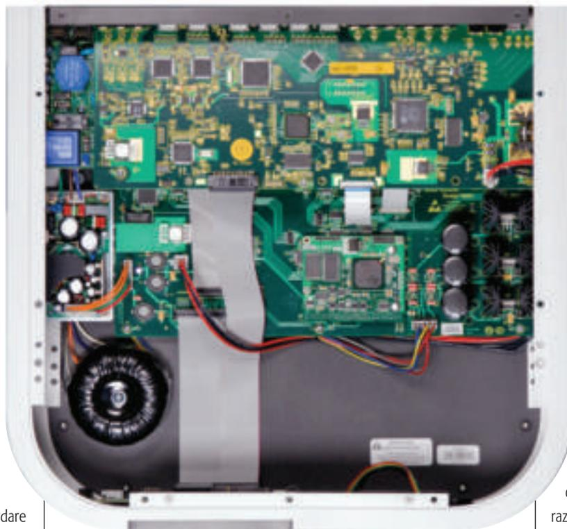
*Da accademia dell'elettronica il preampli digitale SSP-800, con un lay-out circuitale esemplare per nettezza realizzativa, materiali impiegati, ingegnerizzazione. Da notare il toroidale per l'alimentazione. Spettacolare il profilo curvo dello chassis, di notevole massa e spessore.*
