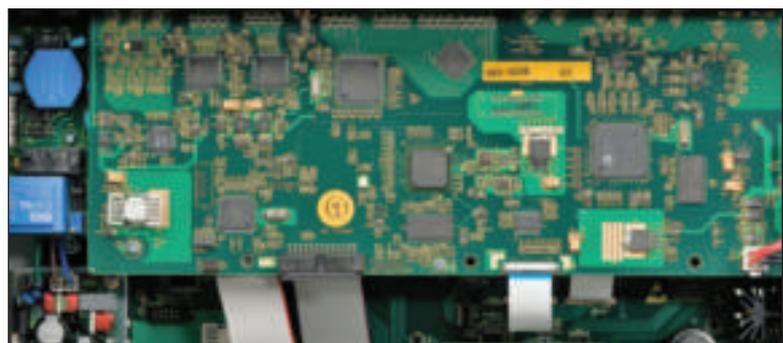
Particolare della circuitazione interna, dove è possibile accedere al DSP Texas Instruments per sostituirlo in caso di aggiornamento.
