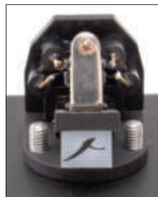
Vista frontale della Sumiko Blackbird così come appare fissata al suo contenitore. Spicca in primo piano il gruppo magnetico e, in asse, il cantilever, in boro.
