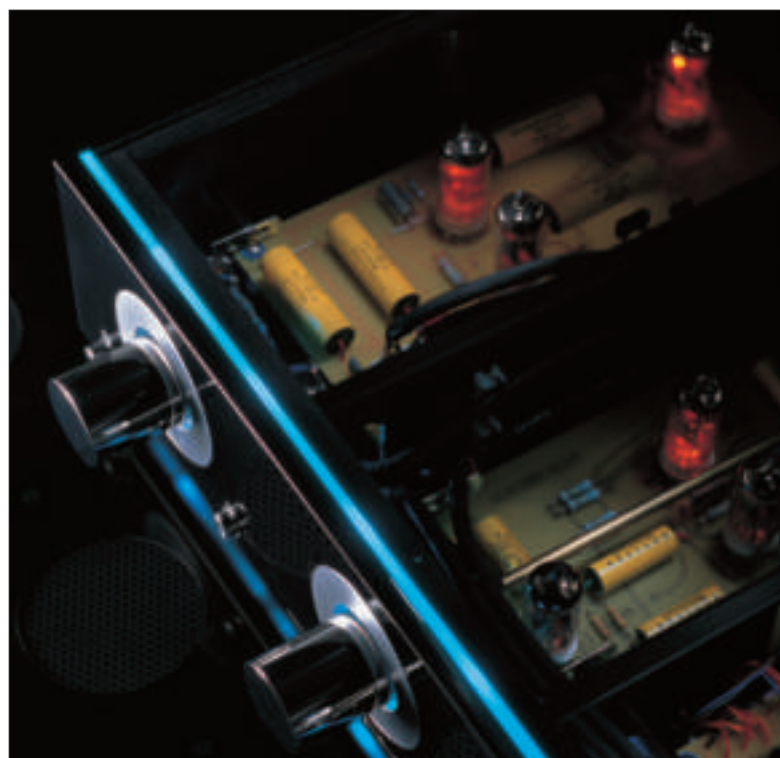
Squisitamente "hand-made" la costruzione dell'HP100, con utilizzo di molti componenti interni -come i condensatori- costruiti in casa Hovland e ad-hoc per il prodotto.
