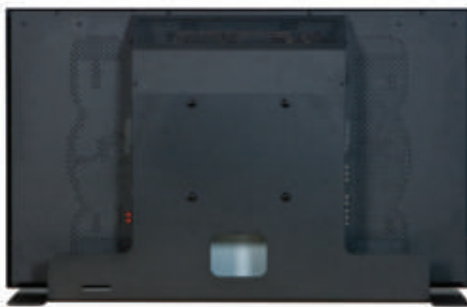
Il PD-420, come tutti gli altri modelli di LCD Planar, è costruito secondo specifiche professionali e dotato di chassis completamente in metallo, il che lo rende eccezionalmente robusto e in grado di smaltire molto più agevolmente il calore generato.
