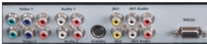
Oltre i numerosi ingressi HDMI, presenti su un altro pannello, possiamo notare l'ingente numero di input analogici, tra component, SVideo e composito presenti sul PD-420.
