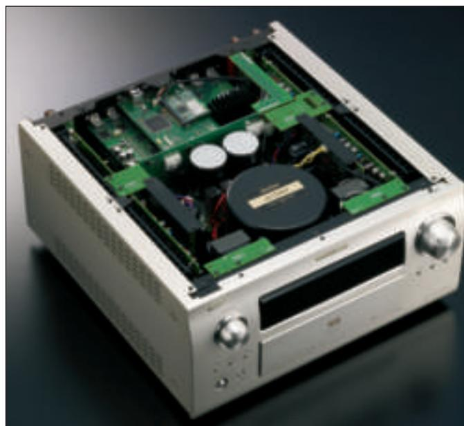
*Numerose le sezioni di alimentazione. In evidenza il grosso trasformatore toroidale che alimenta le amplificazioni di potenza insieme con i 2 elettrolitici di livellamento. Nell'AVC-A1 HD sono presenti 7 diversi trasformatori dedicati ognuno a una particolare circuitazione per evitare interferenze.*
