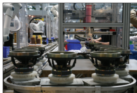
Tre importanti fasi di lavorazione degli altoparlanti. La prima foto mostra la distribuzione del collante per le membrane dei woofer della 802D, nella seconda le membrane sono messe in opera e tenute in pressione con un anello metallico, mentre l'ultima mostra l'incollaggio del parapolvere.
