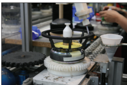
Tre importanti fasi di lavorazione degli altoparlanti. La prima foto mostra la distribuzione del collante per le membrane dei woofer della 802D, nella seconda le membrane sono messe in opera e tenute in pressione con un anello metallico, mentre l'ultima mostra l'incollaggio del parapolvere.
