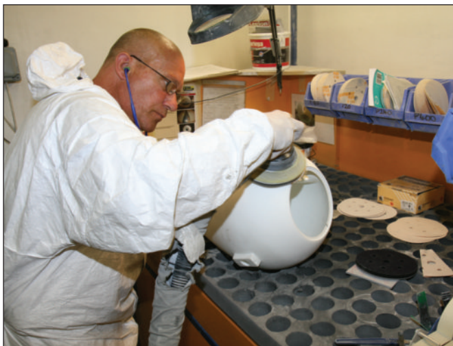
La levigazione di una delle teste Marlan semilavorate, che precede la verniciatura a forno fatta completamente a mano
