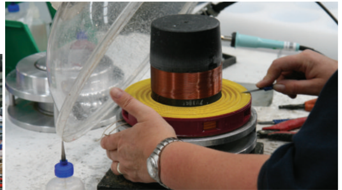
La fase di incollaggio di uno spider in nomex per un woofer della 800D. Notare la corposa bobina mobile in evidenza, e sotto, il grosso motore magnetico.
