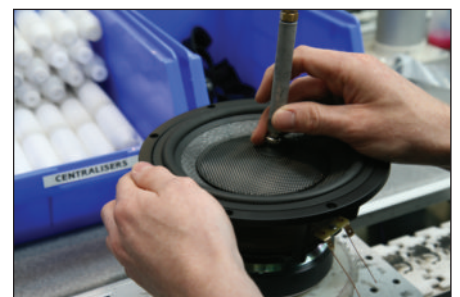
Tre importanti fasi di lavorazione degli altoparlanti. La prima foto mostra la distribuzione del collante per le membrane dei woofer della 802D, nella seconda le membrane sono messe in opera e tenute in pressione con un anello metallico, mentre l'ultima mostra l'incollaggio del parapolvere.
