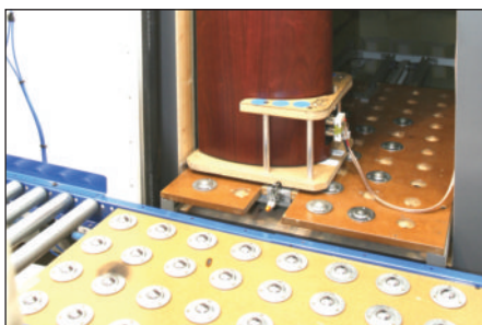
Il diffusore finito viene inserito nella camera anecoica per la misura definitiva. L'operatore indossa la cuffia per ascoltare lo sweep di rumore rosa, la risposta in frequenza evidenzia un problema sulle basse frequenze, e infatti, foto finale, una delle sospensioni è leggermente scollata.
