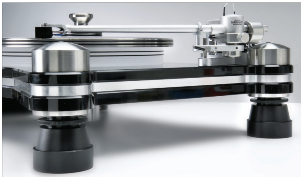
La base che costituisce l'HR-X è un sandwich di medite-alluminio-medite che poggia su supporti isolanti di grandi dimensioni. Una soluzione molto efficace dal punto di vista sonico e che ha visto successivi miglioramenti nel corso degli anni.
