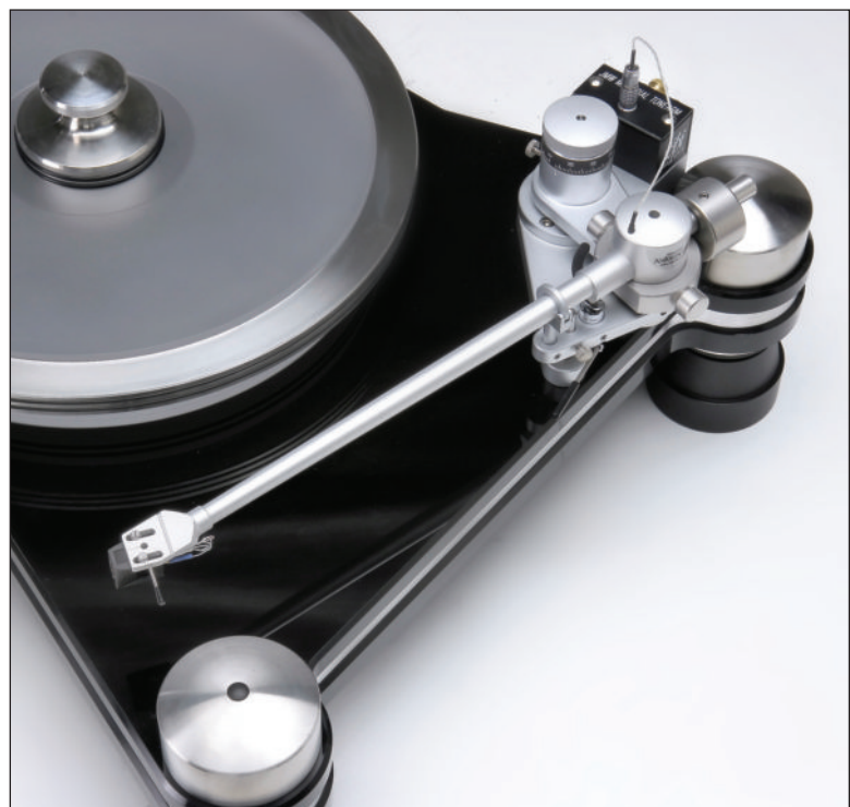
Il JWM 12,7 è un braccio Unipivot con una canna particolarmente lunga, tra le più estese in commercio. Questo permette di contenere al minimo l'errore di tracciamento.
