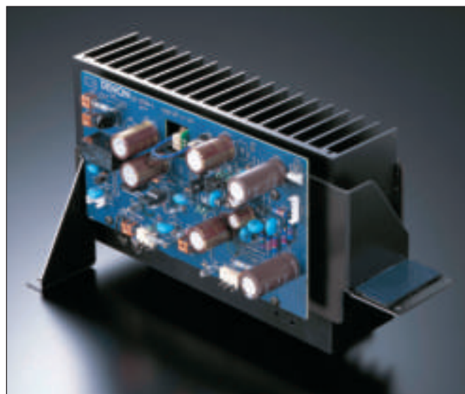
Una delle sezioni di potenza del PMA-2000AE. I transistor di potenza sono assicurati direttamente sulla grande aletta di raffreddamento, come anche gli stadi driver. La componentistica è molto selezionata, e la costruzione estremamente razionale.
