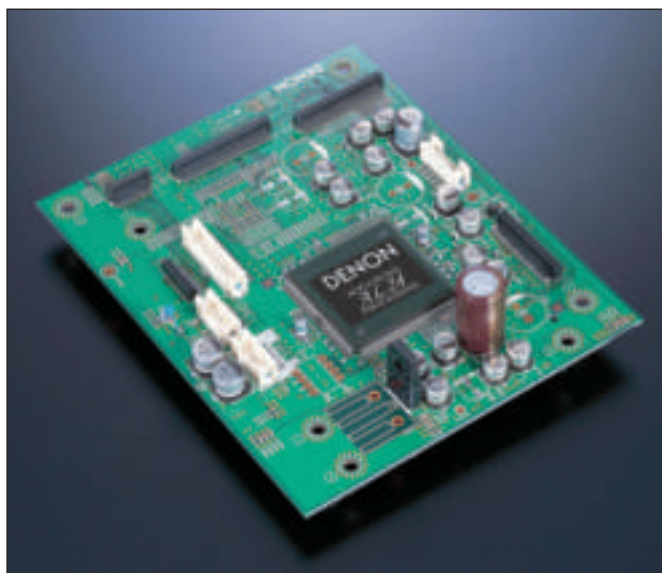
Il circuito di conversione all'interno del DCD-2000AE utilizza un chip proprietario Denon e un Burr Brown DSD 1790 di ultimissima generazione (posto sull'altro lato della scheda). Il tutto concorre all'eccezionale suono di questo lettore.
