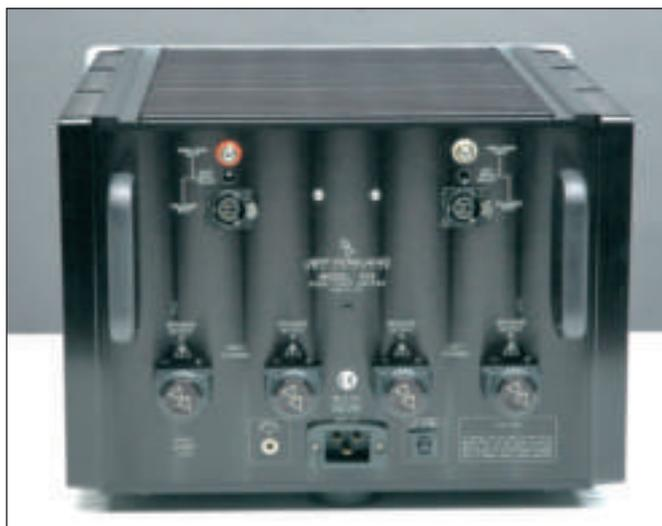
*Il telaio che ospita sia il Synergy III che il Model 312, è in alluminio tornito dal pieno ed è di elevata spessore. La forma interna è particolare, ad "H" non risonante, ed è frutto di studi tesi a minimizzare la trasmissione delle vibrazioni. Ogni particolare delle elettroniche Jeff Rowland, è studiato nei minimi dettagli in funzione della massime prestazioni sonore. Notare i generosi morsetti di uscita per altoparlanti, in grado di serrare in modo energico qualsiasi tipo di cavo.*
