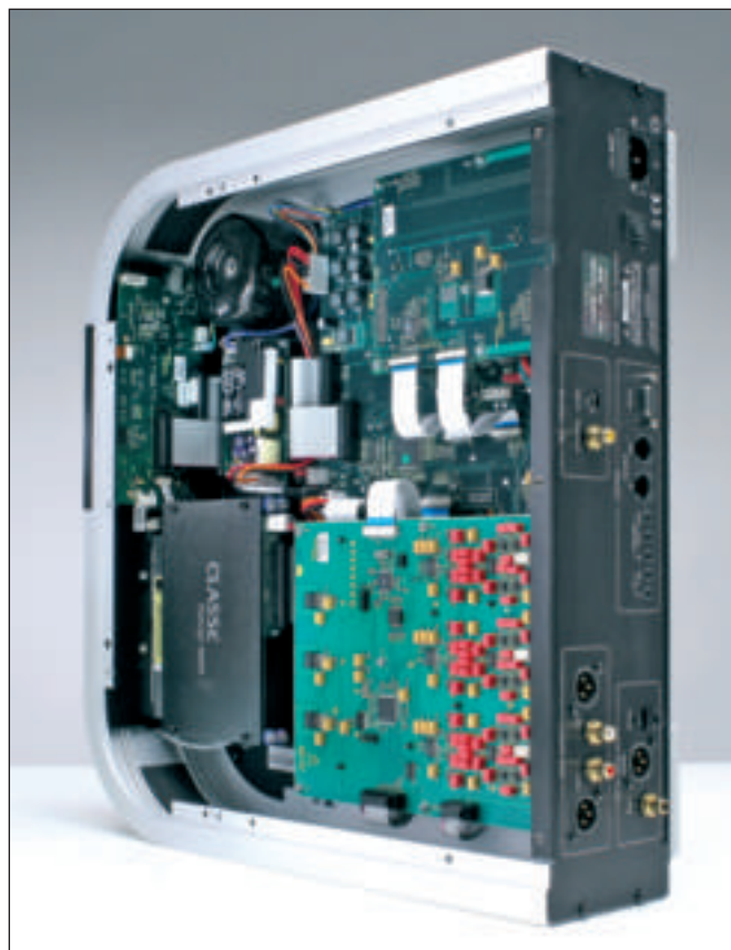
La costruzione interna è da manuale. I componenti utilizzati sono tutti di livello elevatissimo e selezionati all'ascolto. Notare in alto a destra la doppia alimentazione, una toroidale per la parte audio analogica e una switching per tutti i circuiti digitali.
