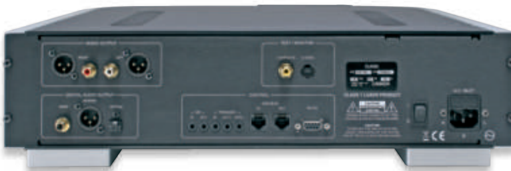
Attraverso il display LCD TFT touch screen è possibile fruire della preview video dei DVD-Video e Audio, come comandare completamente il lettore. Le uscite disponibili: XLR bilanciati o PIN RCA sbilanciati, sia per la parte audio che per quella digitale.
