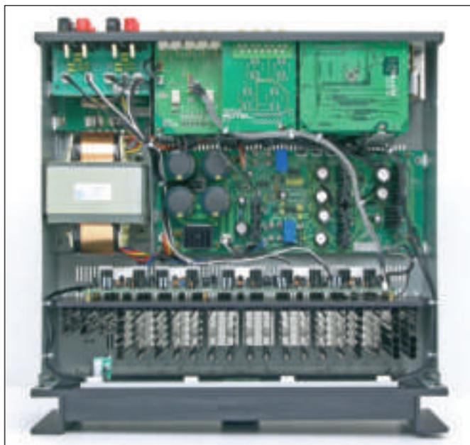
La costruzione è molto razionale. Il grosso trasformatore di alimentazione fornisce energia per 5 stadi di potenza -tutta la parte in basso a ridosso del frontale- in grado di erogare ben 75Wx5 in regime continuo con tutti i canali in funzione.
