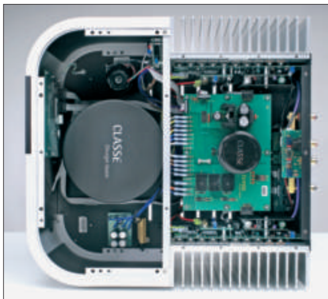
L'interno del CAM-400 è impressionante, notare l'enorme toroidale principale di alimentazione coadiuvato da altri due trasformatori, uno per i driver e uno per i servizi.
